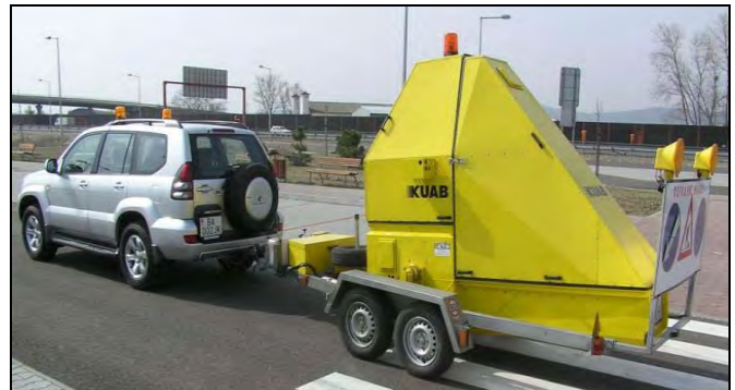
VIDEOVOZIDLO - zariadenie na rýchle vizuálne prehliadky vozoviek VIDEOCAR – equipment for quick visual inspection of pavement
