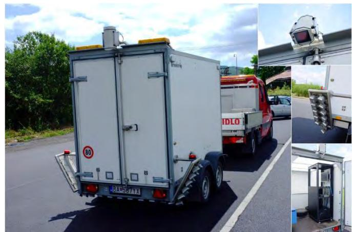
V zmysle **TP 053 – Metodika merania a vyhodnocovania stavu povrchu vozovky pomocou zariadenia LineScan** sa vykonáva hodnotenie stavu povrchu vozovky kamerovým systémom LineScan . TP 053 stanovuje metodiku merania a vyhodnocovania stavu povrchu vozoviek pomocou automatizovaného zariadenia LineScan na snímanie povrchu a vyhodnotenia videodát.
