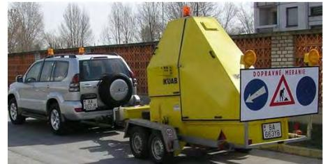
Deflektometer FWD je zariadenie na rázovú zaťažovaciu skúšku vozoviek generujúce zaťaženie pádom bremena na tlmiace podložky uložené na povrchu kruhovej zaťažovacej dosky, ktorá je v kontakte s podložím alebo vozovko.
